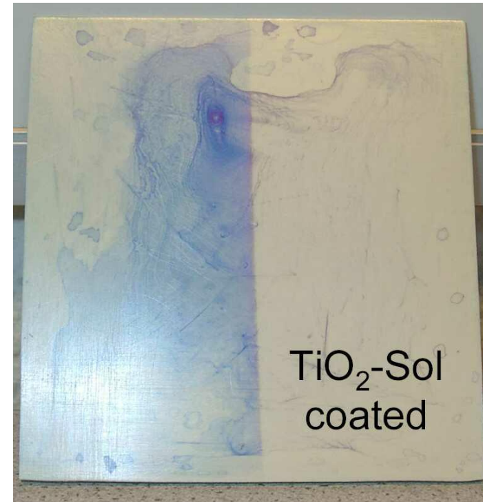
Prikaz samočistilnega efekta
